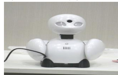
写真3 コミュニケーションロボット（おりひめ）カメラ、マイク、スピーカーが搭載されておりインターネットを通して操作できます。その人がそこにいるように会話できます。遠隔分身ロボットです。
