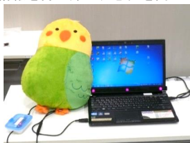
写真2 視線入力装置：ゲームで入力が体験できるように開発されています。
