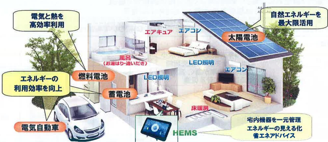
燃料電池・太陽電池・蓄電池(電気自動車)の3電池を活用し、
