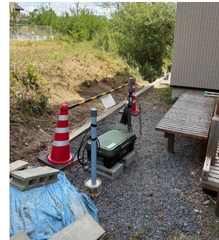
地下水位、孔内歪み観測状況
