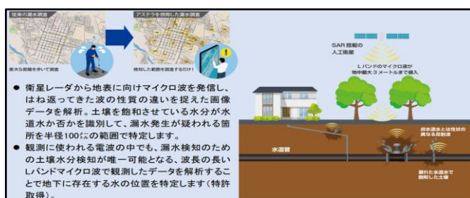
人工衛星を活用した漏水調査
