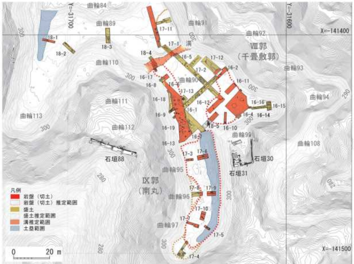
図3 VIII郭・IX郭で確認された切土・盛土の範囲
