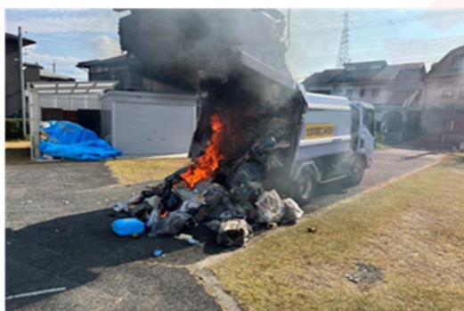
図 大津市の回収車におけるリチウムイオン蓄電池混入による火災事故
