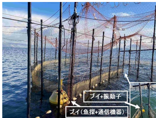
図1 エリのツボに設置した魚探
