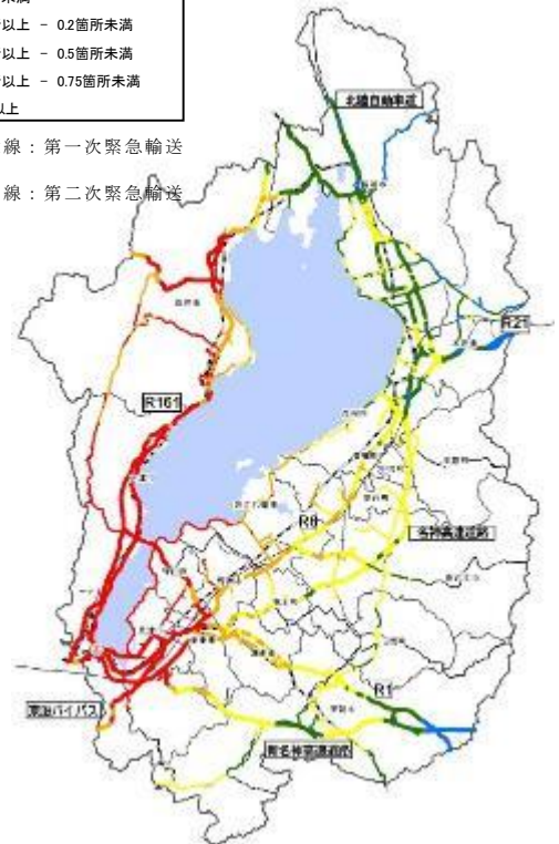
緊急輸送道路における道路被害箇所率図
