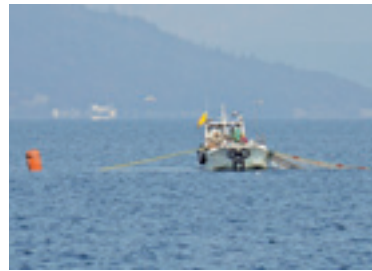
沖びき網 船をいかりで固定して、網を引き寄せて魚を獲る底引き網の一種です。
