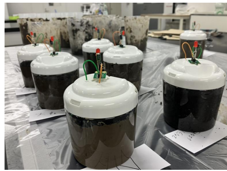
サイト内で採集した土を使った 微生物発電実験
