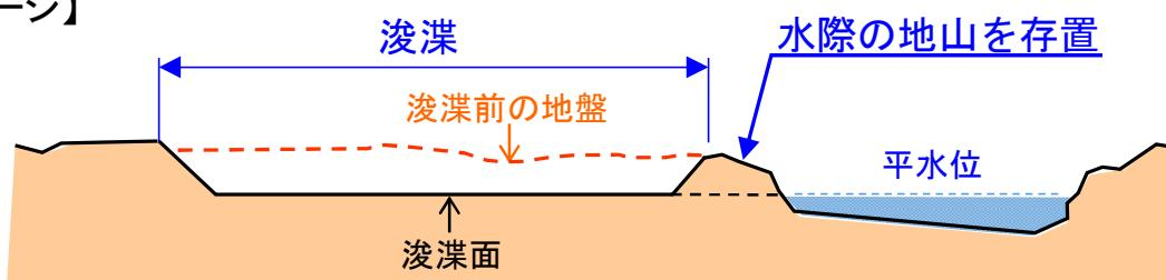
※ 浚渫面に植生が回復するなど安定した後、存置した水際の地山を撤去します。
