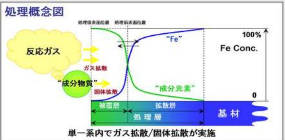
拡散浸透法は、拡散反応、積層反応が同時に生じる処理法である。
