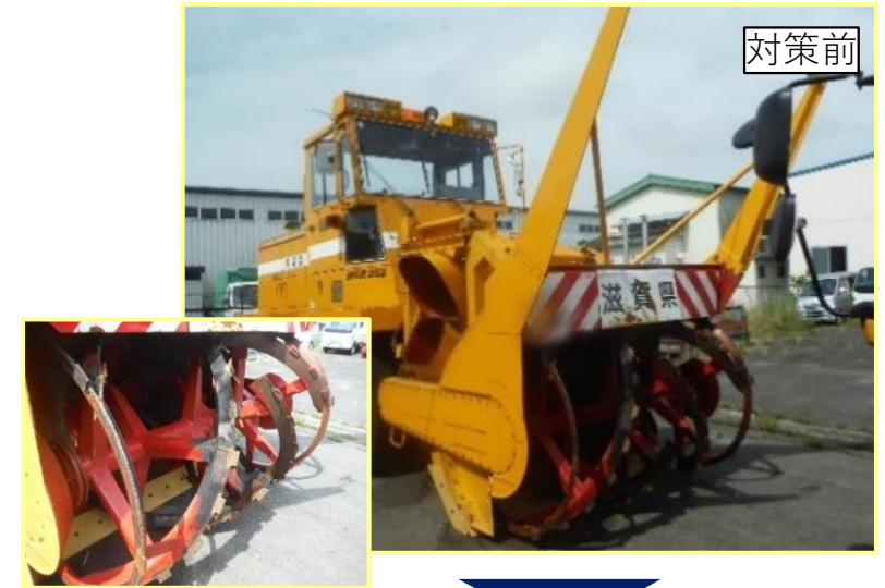
雪寒用建設機械の損傷状況（除雪ローダ（購入後24年））
