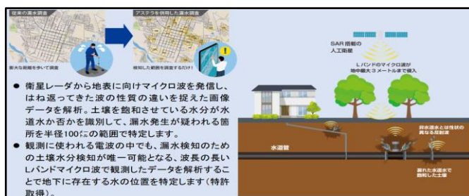
人工衛星を活用した漏水調査
