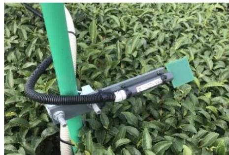
図 1 葉面濡れセンサー (Onset 社製「S-LWA-M003」)
