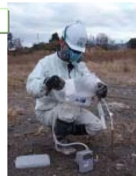
写真-1 ガス採取状況(例)
