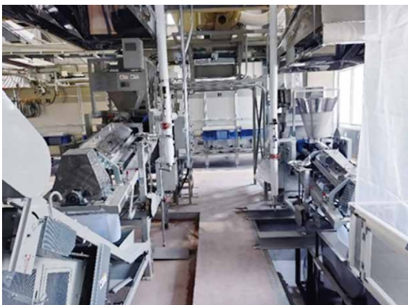
硬化した芽専用の大型蒸機（左）と従来の蒸機（右）
