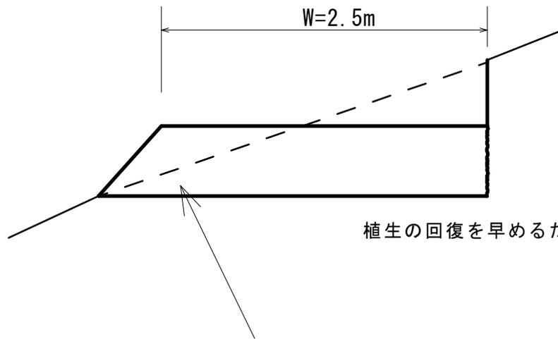
盛土が安定するように基礎掘削、転圧を実施する。
