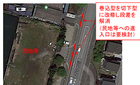
専用道路の巻込部の段差改善
