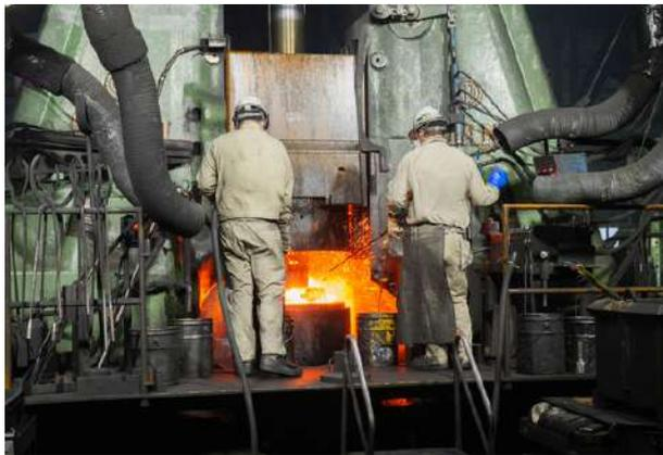
金属を再結晶温度以上に加熱し、鍛造機械に取り付けられた上下の金型で加圧し塑性加工を行う熱間型打鍛造。
