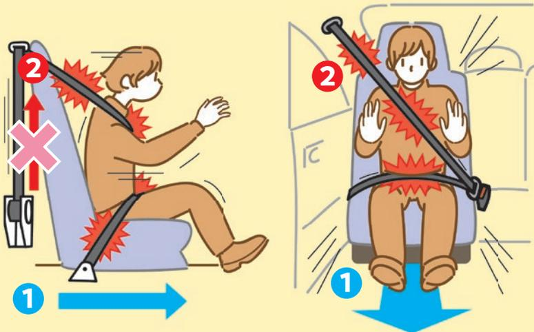
前面衝突のような交通事故時には、慣性により前に進むとする身体を座席に拘束するシートベルトにより、胸と腰には非常に大きな力がかかります。そのような大きな力に耐えるため、肩ベルトは肩にかけ、腰ベルトは骨盤をしっかり固定する必要があります。
