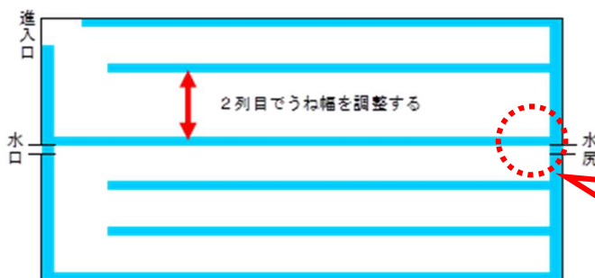
図 ほ場内の効果的な明渠施工例
