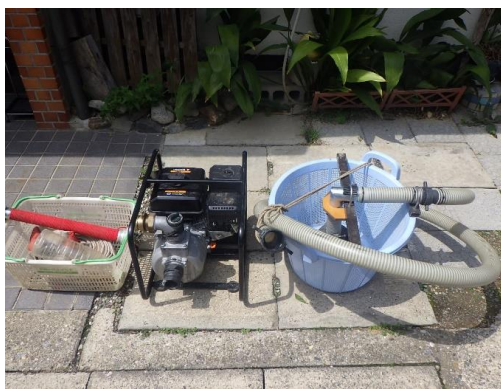
ジェットポンプ(ポンプ部): 高水圧で土壌を液状化させる。地中に深く張った根茎を掘り起こす際に用いる。
