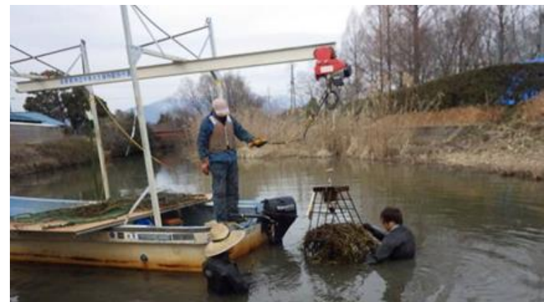
小型のクラムシェルを搭載した小型船
