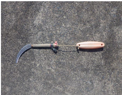
カマ: 密生した植物の切断等に用いる。
