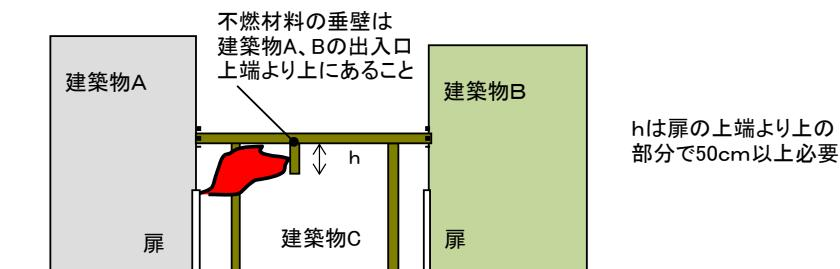
⑨接続部はエキスパンションジョイント等により、相互に応力を伝えない構造であること。また、建築物相互の離隔距離は取扱基準4-3-01 1.①および2.によること。
