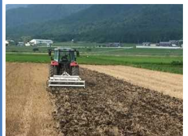
写真3 スタブルカルチでの粗耕起
