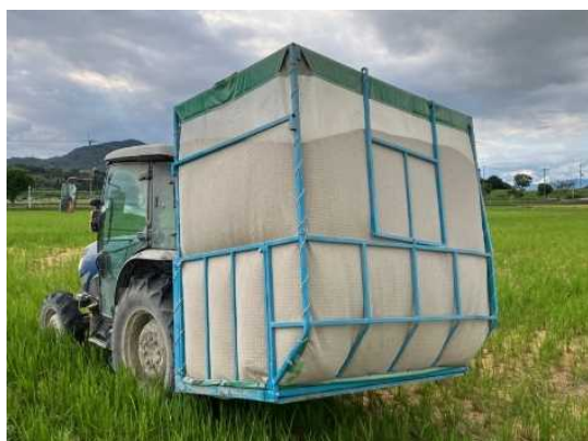
写真2 もみ殻散布機による施用
