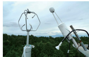
写真4-16-2 森林の二酸化炭素交換速度の計測の様子
