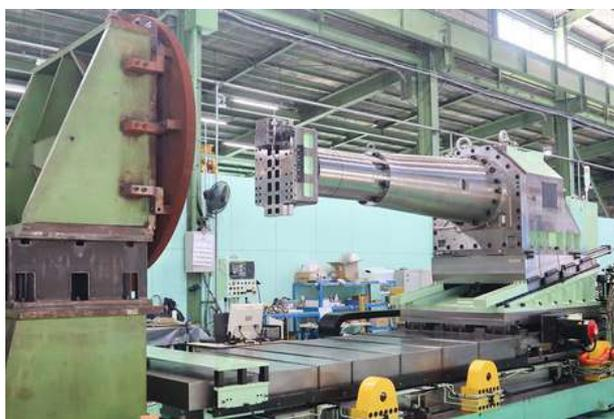
FLEX U+RUDDERはCNCフェーシングヘッド（U軸）を基本搭載し、CNC3軸（X,Y,Z）制御コラムを備えている4軸横型CNCフェーシング加工機です。
