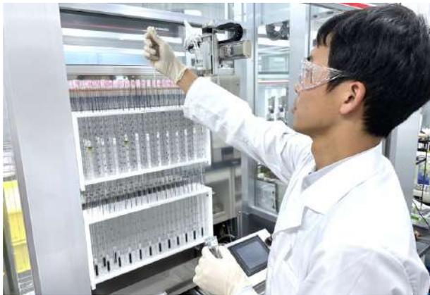
当社のケイラックス®技術は、細胞の生物応答を利用してダイオキシン類を測定するバイオアッセイです。HRGC/MS法と比較し、高感度かつ短時間で評価が可能です。簡便な前処理により低コストを実現し、HRGC/MS法と高い相関性を持つため信頼性にも優れています。また、機器を省スペース化し試薬の使用も少量に抑えることで、CO<sub>2</sub>削減を可能にした環境配慮型の技術です。
