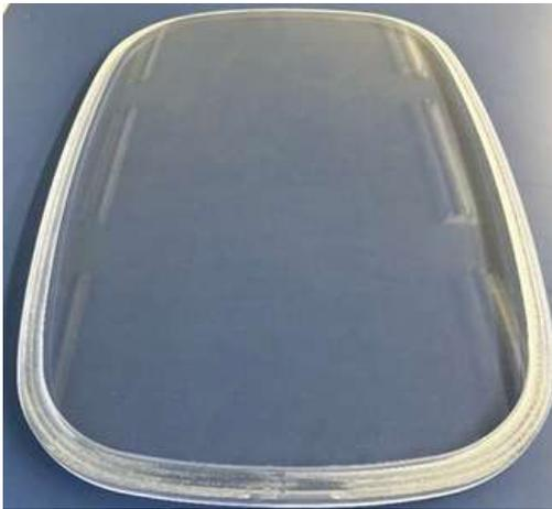
ポリカーボネートは、ガラスの200倍以上の耐衝撃性、1/2の重量、遜色のない透明度など非常に優れた素材です。このことからガラスに代わる窓やカバー向けの素材として使用されています。しかしながら、曲げ加工したポリカーボネートは、大きな歪みが発生して透明感が損なわれ、また歪んだ箇所から割れにつながることもあるため、加工形状には制約があることも事実です。
