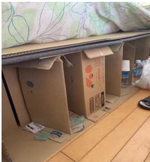
段ボールベッドの劣化確認
