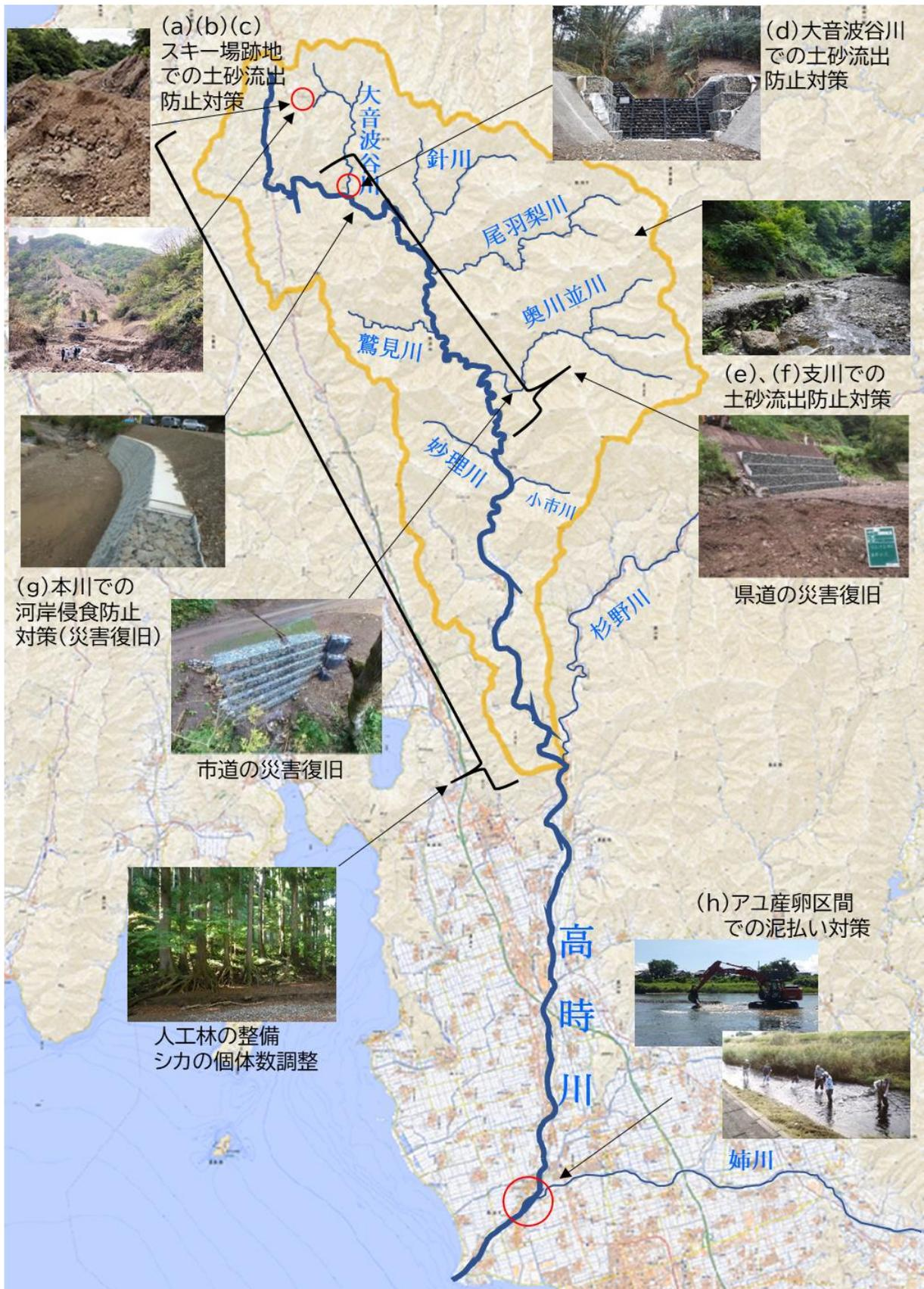
図 32： 高時川濁水対策計画位置図
