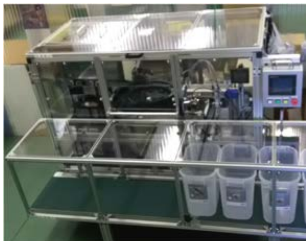
自動車部品向け成形品自動不良選別機 (H26年度ものづくり補助金にて開発したものです)
