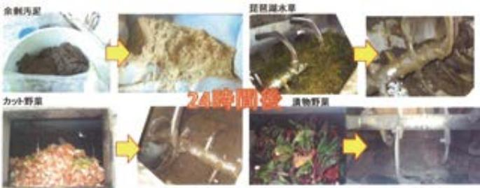
世界的な問題になっている余剰汚泥の含水率の低下、生ゴミ処理の消滅化、不要な野菜・果物を成分そのままに粉末化することで保存・再利用が可能になります。また、メタン発電の前処理利用で、コンパクトな発電設備になります。
