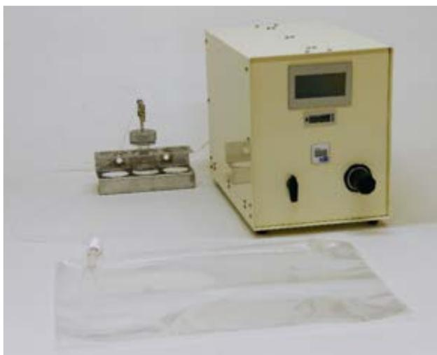
SHC-3サンプリングバッグ加熱加湿洗浄装置
