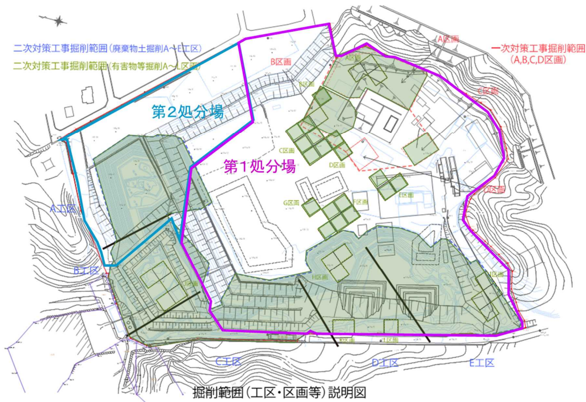
図〇 遮水工等の施工に伴い掘削が必要となった範囲（有害物等掘削除去工を除く）
