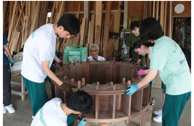
写真5 水車の組み立て作業
