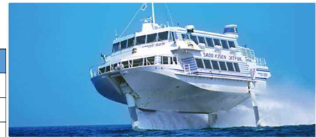
ジェットfoil 船名: さんが、つばき、まいせい 最大旅客定員: 250人 新潟～両津航路、直江津～小木航路 最大速力: 46ノット 燃費効率: 7.69pph
