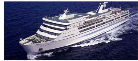
カーフェリー 船名: おけさ丸 最大旅客定員: 1,705人 新潟～両津航路 最大速力: 23.4ノット 全長: 134.7m 最大幅: 23.0m 主機関種類: ディーゼル
