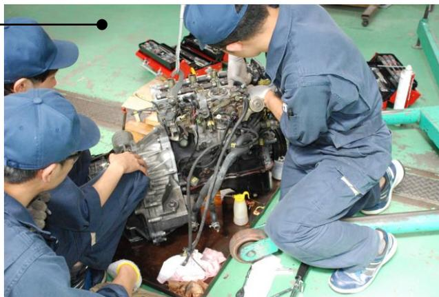
この実習では実際の車両からエンジンなどを取り外し分解・測定・洗浄・組立をします。エンジンはネジなどを含めると、数万個の部品で構成されています。1台の車に少人数での作業なので理解力が付きます。エンジンが掛かるとみんなで大喜びです。
