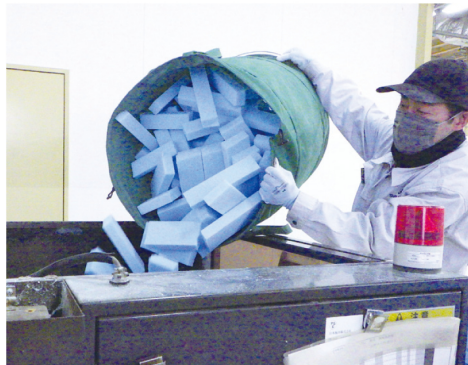
減容化設備への端材の投入
