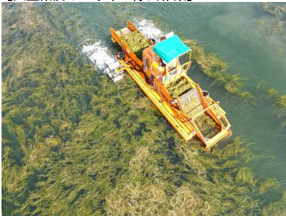
[大量繁茂した水草の除去作業]
