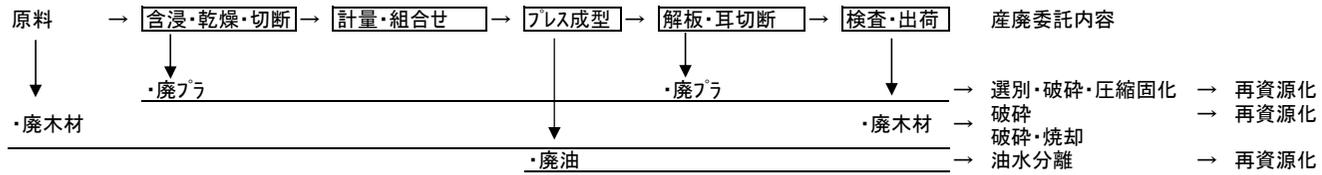
・紙、布、ガラス基材樹脂積層管製造工程より
