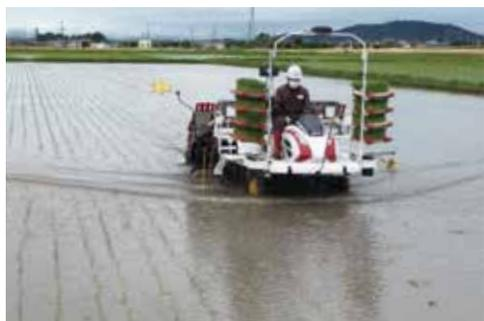
GPSが搭載されており、直進作業行程で自動走行を行うことができるため、深水で回転マーカのラインが見えなくても田植が可能になります。また、自動直進中は操舵を行う必要がなく、苗の補給や植付け状況の確認等を行うことができます。
