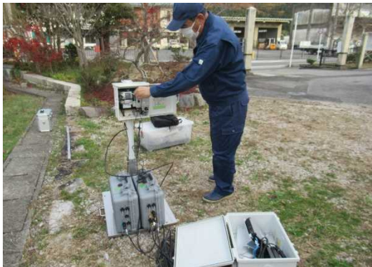
可搬型モニタリングポストの設置
