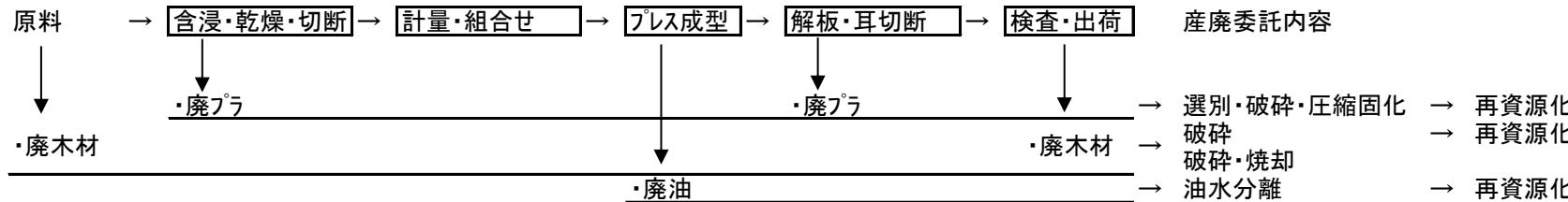
・紙、布、ガラス基材樹脂積層管製造工程より
