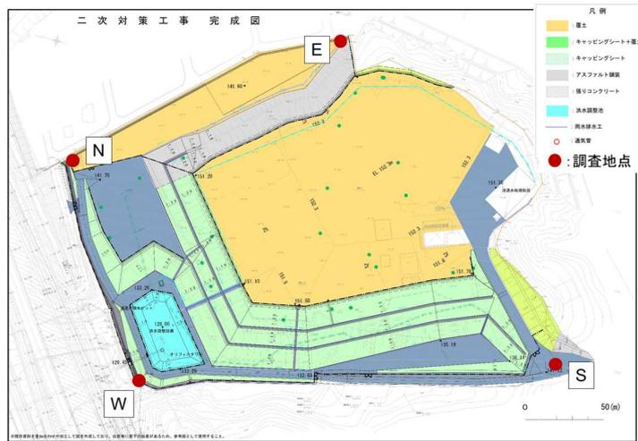
② 調査方法 大気ガスを採取分析し、硫化水素ガス濃度を調査する
