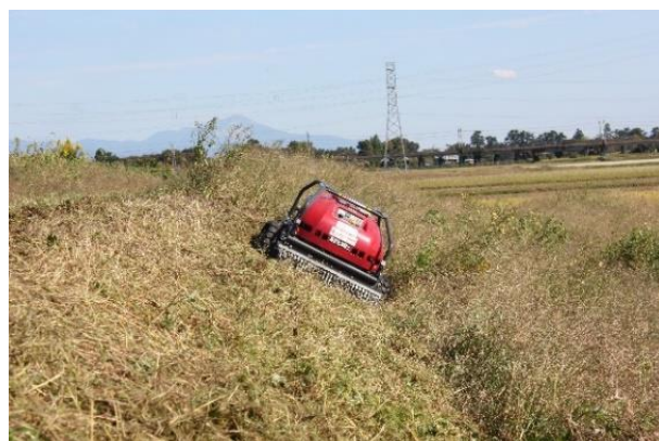
草刈り作業風景（傾斜角は約 30 度）
