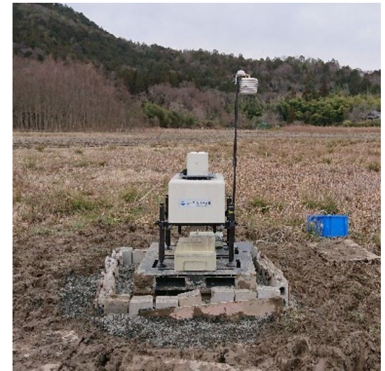
ドップラーライダー設置状況
