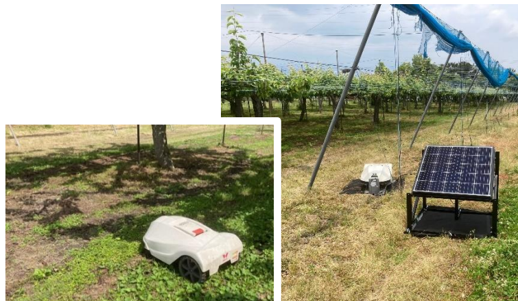
太陽光パネルによる充電後、自動除草するロボット草刈り機
