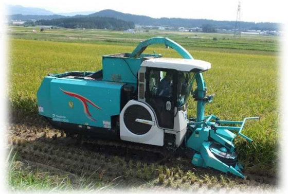
汎用型飼料収穫機を利用した コントラクターによる稲WCSの収穫
