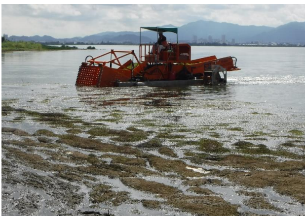
[大量繁茂した水草の除去作業]
