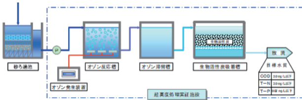
超高度処理実証施設フローシート
