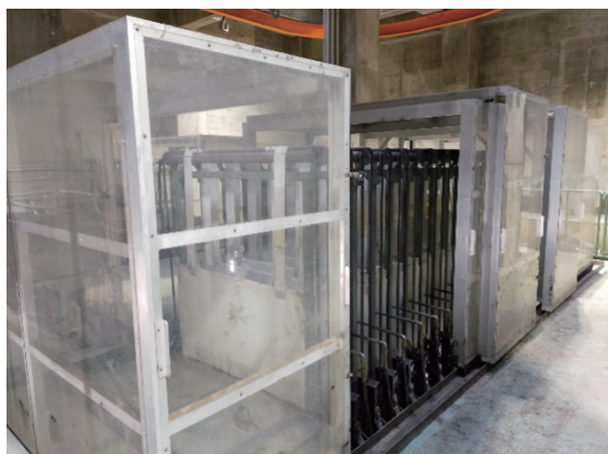
フィルタープレス式脱水機
