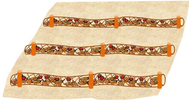
図 4.1.4 ヤシ繊維ネットロール筋工
