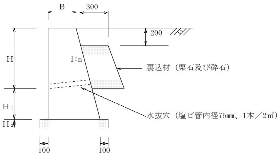
・設計条件 建築物等の荷重が擁壁に作用する場合
