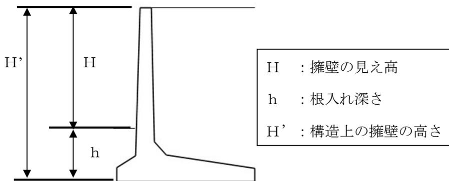
(イ) 道路側溝等に接して設ける擁壁の根入れは、道路面を基準とする。
